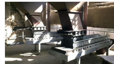
Группа дозаторов непрерывного действия КЛИМ-ВД, установленных на сырьевой мельнице
