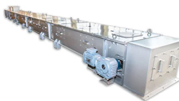
Дозатор непрерывного действия КЛИМ-ВД закрытого типа. Длина конвейера 12 метров
