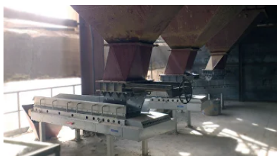
Группа дозаторов непрерывного действия КЛИМ-ВД, установленных на сырьевой мельнице
