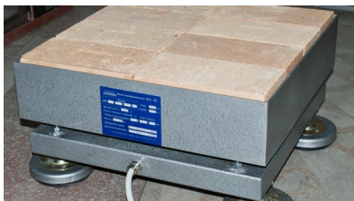
Весы платформенные ВПС-0,06-500-500-С для взвешивания расплавленной капли
